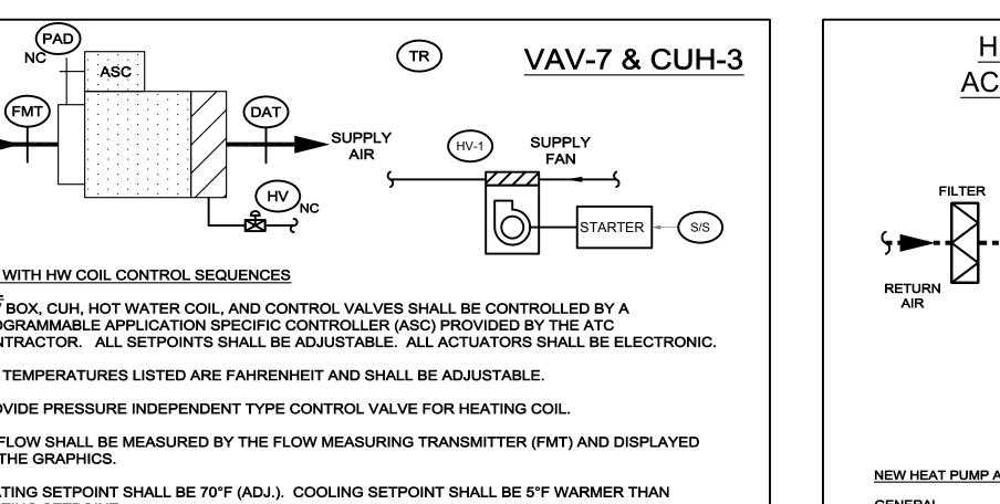
NG SETPOINT. TEMPERATURES SHALL BE SET BY THE BUILDING AUTOMATION SYSTEM (BAS) AND THE OF LOCAL +/- 2°F ADJUSTMENT.
